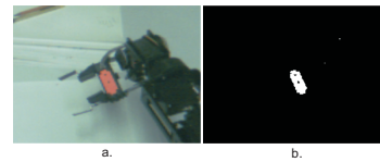
Figura 2. Efector final segmentado de acuerdo a su color
